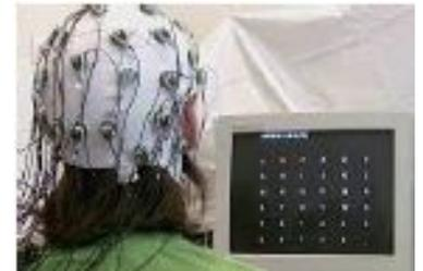
**Application d'ICM à l'homme** : à partir de l'intention d'agir, l'activité cérébrale enregistrée dans les aires motrices est convertie en signaux de commande et entraîne la mise en jeu d'un dispositif.
